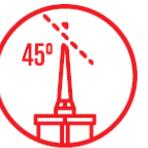
**5.** Remova a tampa do cartucho e conecte o bico injetor. Em seguida, coloque o cartucho no aplicar e corte o bico em 45°.
