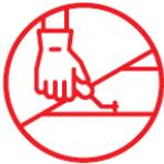
**1.** A fuga precisa ter 2 a 3 mm de profundidade. Por isso, em caso de reforma, faça a remoção do rejunte antigo com o Extrator de Rejunte Hard.
