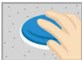
1. A superfície onde será feita a aplicação, deve estar limpa e livre de impurezas, como poeira, óleo, graxa, etc. *Em substratos cimentícios, a umidade é tolerada, porém sem saturação.*
