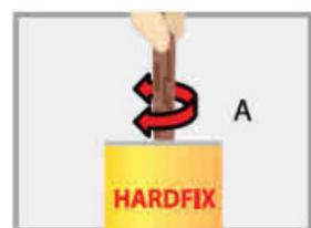
4. Fazer a mistura dos componentes manualmente ou com agitador de baixa rotação até obter uma cor uniforme.
