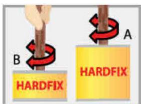
2. Homogeneizar os dois componentes (A e B) separadamente. *Eles podem ter sedimentado durante a armazenagem.*
