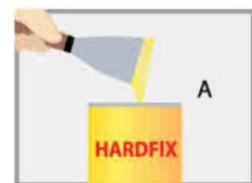
5. A mistura pode ser aplicada manualmente, com o auxílio de uma espátula ou pincel. *Para aplicações de ancoragem deve-se preencher 3/4 do furo com o produto e inserir a barra roscada ou o vergalhão com movimentos circulares até atingir o fundo do furo.*
